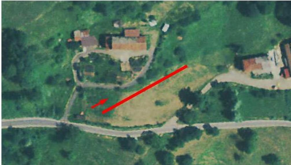
*Figura 13 - Ubicazione planimetrica da immagine aerea. In rosso lo stendimento sismico (fuori scala).*
