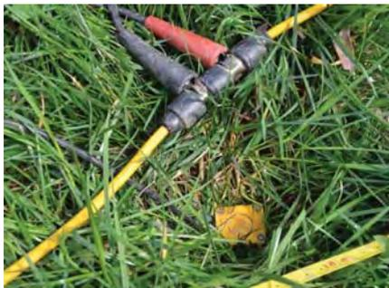
**Figura 4 – Geofono verticale SENSOR SM-6/U-B.**
