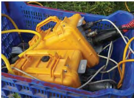
**Figura 3 – Coppia di sismografi Geometrics Geode.**
