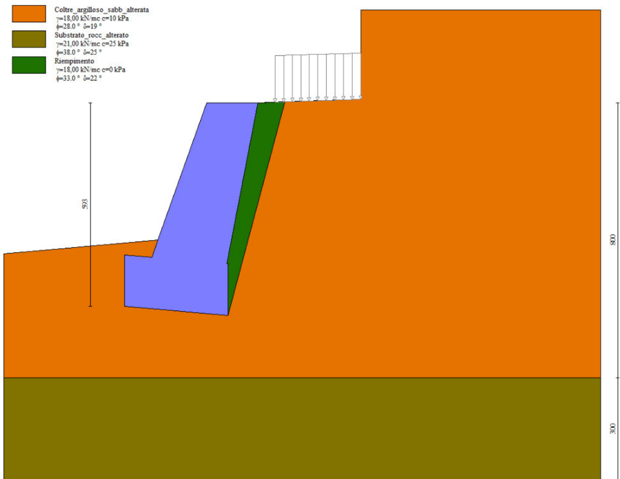
Figura 28: Estratto dal software di calcolo MAX 16.0 – Geometria di modellazione scogliera – intervento 9 in sezione, condizione stratigrafica e di carico.
