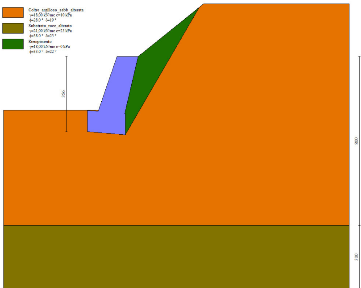
Figura 25: Estratto dal software di calcolo MAX 16.0 – Geometria di modellazione scogliera – intervento 1 in sezione, condizione stratigrafica e di carico.
